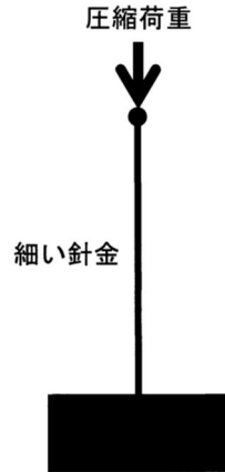
図 上端に圧縮荷重を加えた場合の水平面に垂直に固定した細い針金
