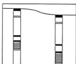
B : ボーリングによる地層の出現深度の違い
